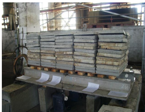
Рис.2 Испытания натуральных образцов плиты L=2400 мм
